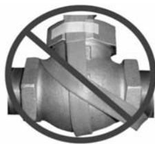
C.) Instalación incorrecta: Cinta calentadora superpuesta sobre sí misma
